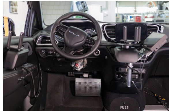
Eine kleine Zeitreise in die PARAVAN-Behindertenmobilität: So (links) sah ein Space Drive Cockpit vor knapp 15 Jahren aus und so (rechts) sieht es heute aus. Die zahlreichen Knöpfe sind verschwunden, dafür findet sich jetzt der PARAVAN Touch als zentrales Bediengerät in fast jedem Cockpit für die Sekundärfunktionen sowie für die Sprachsteuerung. Fotos: PARAVAN
