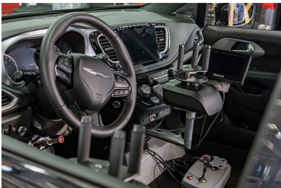
Auch den Chrysler Pacifica wird David wieder mit Space Drive fahren, diesmal mit der zweiten Generation. Gewohnt wird er mit der rechten Hand per Minilenkrad lenken, Gas- und Bremse bedient er mit dem Gas-Brems-Schieber. Foto: PARAVAN
